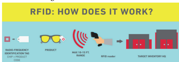
Figura 7. Cómo funciona RFID
