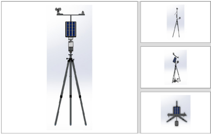
Figura 70. Diseño 3D de estación de metrología completa
