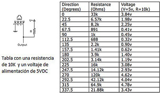
Figura 37. Divisor de voltaje para la dirección del viento
