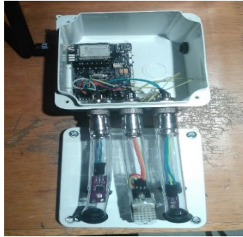
Figura 28. Arreglo de sensores para estación LoRaWAN
