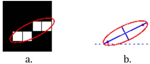
Figura 5-16: Cálculo de la inclinación de la sección del objeto.
