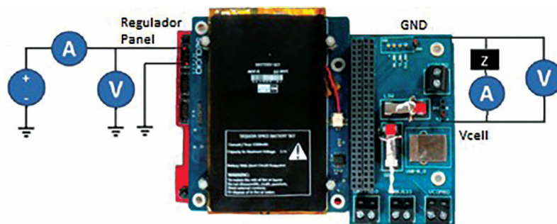
Figura 87. Conexión EPS v3 (regulador individual con carga)
