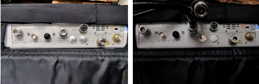
Figura 21. Conexión cable de extensión al VNA Anritsu
