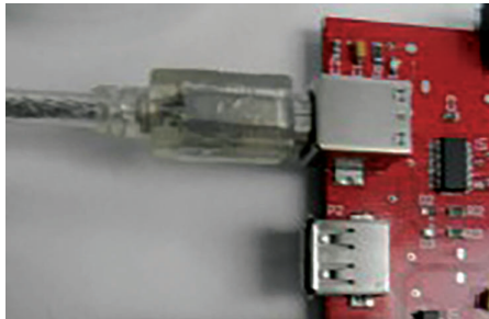
Figura 78. Conexión del cable USB al TNC
