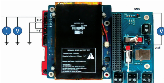
Figura 85. Conexión EPS v3 (combinación de reguladores sin carga)
