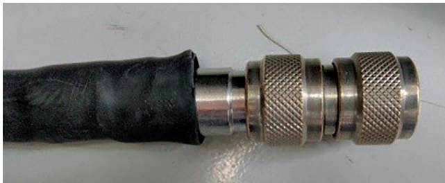
Figura 22. Cable de extensión con conector N-N
