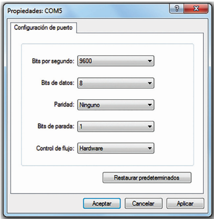
Figura 40. Configuración de parámetros necesarios para comunicación serial
