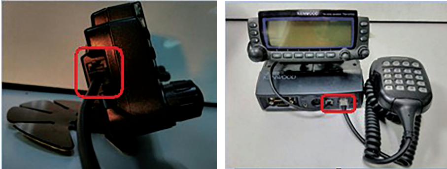
Figura 30. Conexión panel frontal y micrófono al transceiver
