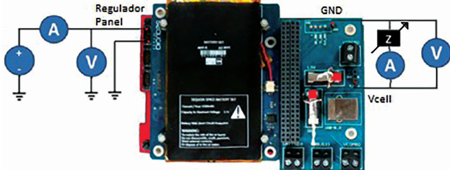
Figura 91. Conexión EPS v3 (regulador individual con variaciones de carga)
