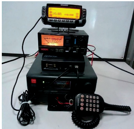
Figura 31. Medidor de potencia y transceptor encendidos
