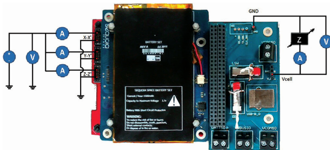
Figura 93. Conexión EPS V3 (combinación de reguladores con variaciones de carga)
