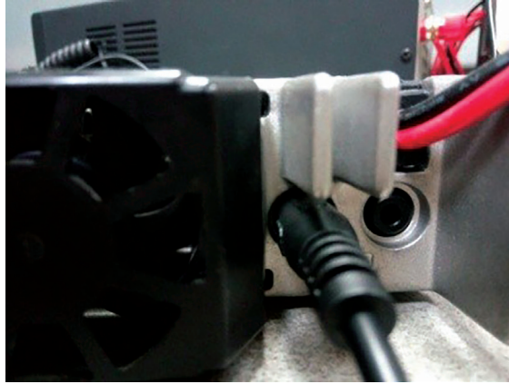
Figura 67. Conexión del cable de audio de 3,5 mm
