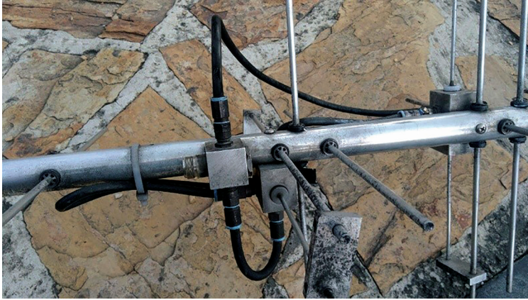
Figura 18. Balun y conectores de la antena de VHF
