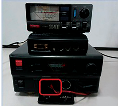
Figura 28. Conexión de la fuente GZV4000 al SX-400
