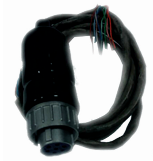
Figura 34. Conector metálico de siete pines
