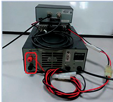
Figura 29. Conexión de la fuente GZV4000 al transceptor
