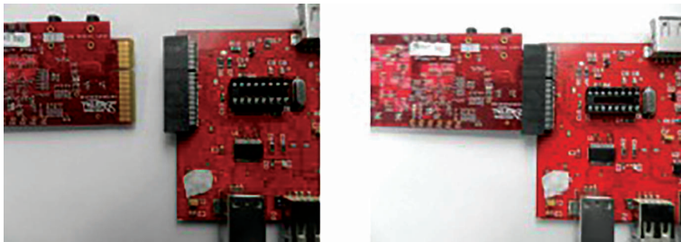
Figura 71. Conexión de la tarjeta de desarrollo a la tarjeta de expansión
