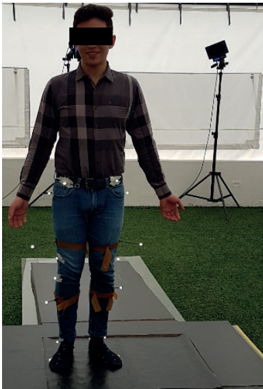
Figura 13. Sistema de plataforma de fuerza con marcadores y cámaras de video
