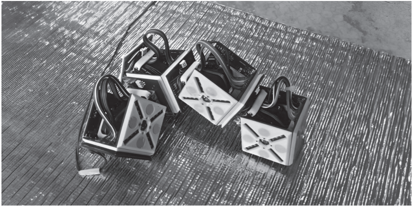
Figura 36. Módulos del robot EMERGE moviéndose a la última posición almacenada y descargada de la nube
