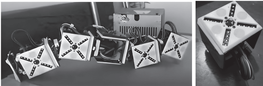
Figura 23. Robot modular EMERGE: ejemplo de ensamble (a) y módulo del robot (b)
