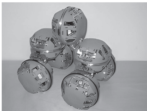
Figura 6. Partes de un módulo y morfología tipo carro del robot modular ATRON: módulo (a) y morfología (b)
