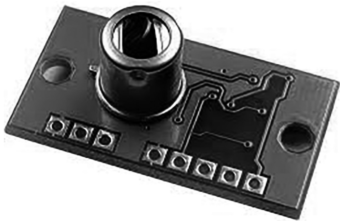
Figura 20. Sensor de calor TPA81
