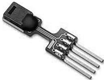
Figura 24. Sensor de humedad relativa y temperatura SHT71
