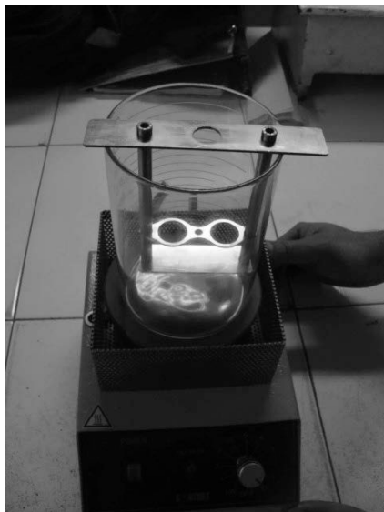
Figura 4. Aparato de anillo y bola
