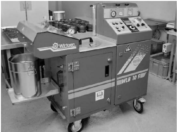
Figura 26. Equipo para espumar asfalto en el laboratorio
