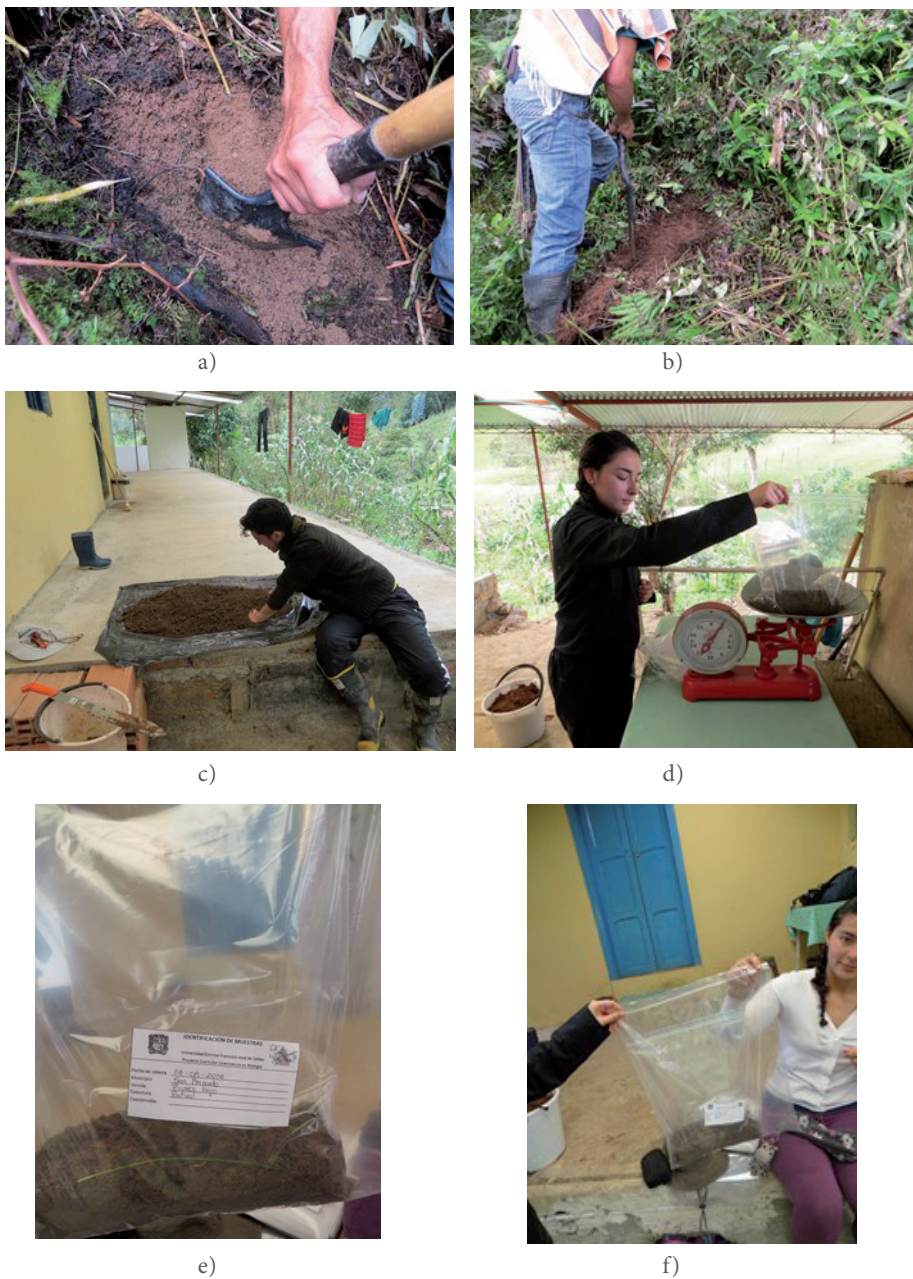
Figura 20. Toma de muestras de suelo: a) apertura del hoyo, b) mezcla y traslado, c) homogeneización, d) pesaje, e) rotulación, f) empaque
