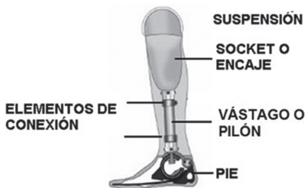
Figura 5. Prótesis transtibial con sus principales componentes
