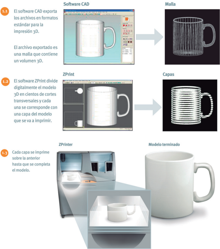
Figura 26. Proceso de generación de sólidos 3D, mediante el uso de impresoras 3D
